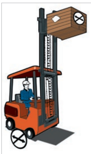
obr. 1 Nejazdiť so zdvihnutým nákladom
